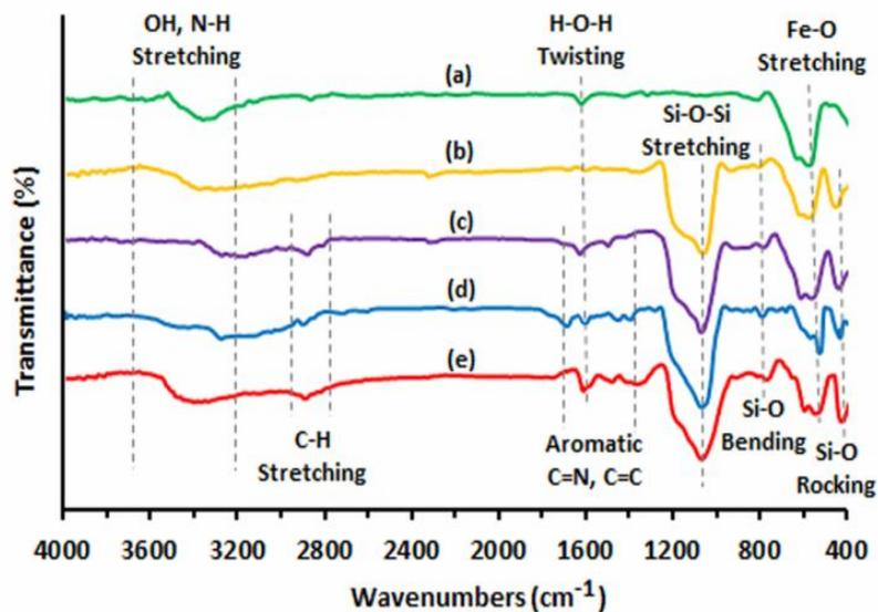
**Fig. 1.** The FT-IR spectra for (a)  $\text{Fe}_3\text{O}_4$ , (b)  $\text{Fe}_3\text{O}_4@\text{SiO}_2$ , (c)  $\text{Fe}_3\text{O}_4@\text{SiO}_2\text{-PrNH}_2$ , (d)  $\text{Fe}_3\text{O}_4@\text{SiO}_2\text{-TDCl}_2$  and (e) MNPs-TBAN nanomaterials.
